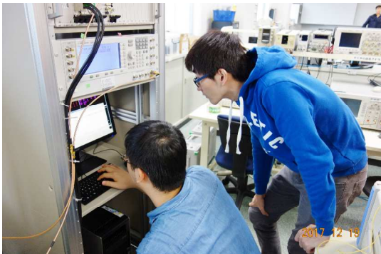
高周波低雑音増幅器(LNA)を設計・作製し、中心周波数 2.5GHz、帯域 80MHz、256QAM 変調の IEEE802.11ac デジタル無線信号の変調特性を評価しました。
