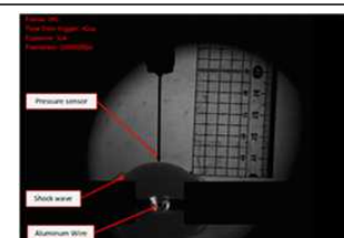
図 3 水中衝撃波の可視化写真
