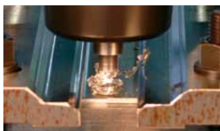
摩擦攪拌接合による加工 The processing of Friction Stir Welding
