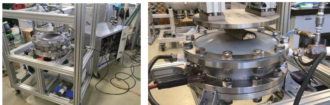
図2 漆師部の剥離のための衝撃波処理装置 (写真左：装置全容、写真右：処理部圧力容器)
