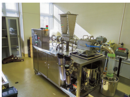
岩手県、岩手県工業技術センター、沖縄高専が共同で実施した農水省補助事業において沖縄高専が開発した衝撃波処理装置
