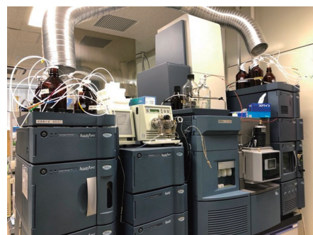
天然物から有用な化合物を分離し、分子の精密な質量を測定する分析機器
