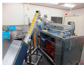
図 4 北限ユズの衝撃波処理装置
