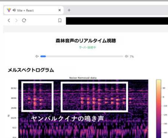
図 2：音声およびメルスペクトログラムのリアルタイム視聴画面（ブラウザ上）
