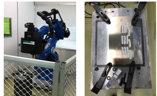
図5 ロボット摩擦攪拌接合装置 (R3.10 トライエンジニアリング (株) 様より貸与)
