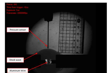
図 3 水中衝撃波の可視化写真
