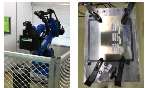
図5 ロボット摩擦攪拌接合装置と施工状況 (R3.10 トライエンジニアリング (株) 様より貸与)
