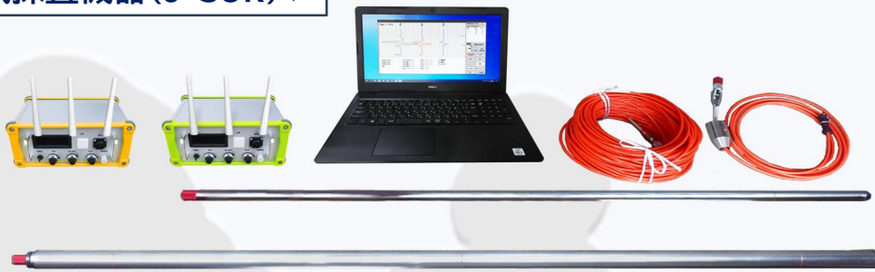
フラックスメーター(+ケーブル+アンプ) ※自社開発機器
