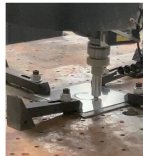
(a) 重ね FSSW 継手外観 (難燃性 Mg/めっき鋼板十字継手) (b) 突合せ FSW 線接合 (Al/SPCC 突合せ) (c) 円周 FSP 施工 (Al 合金板)
