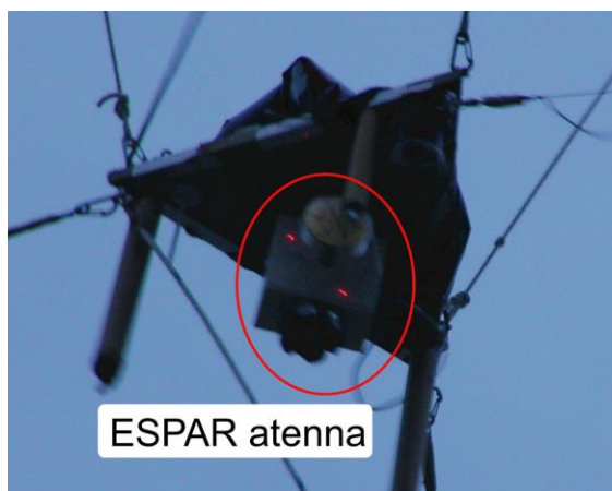
図11 実験時のESPARアンテナ
