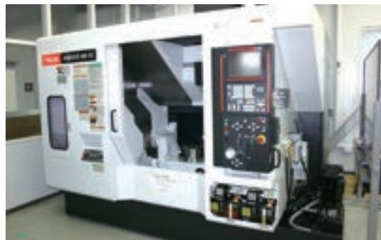
5軸制御マシニングセンター Five Axis Control Machining Center
