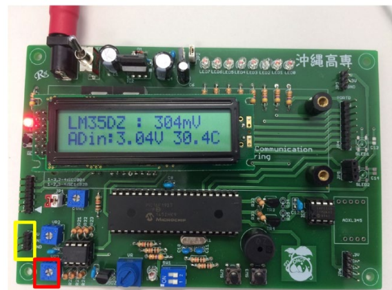
黄枠: 外部入力コネクタ (赤: 5V、黒: GND、紫: AIN) 赤枠: ボード上の温度センサ IC LM35DZ の Gain 調整用可変抵抗 (VR3)
