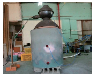
図1 カートリッジ式炭化装置 （撮影：AID テクノロジー社内）
