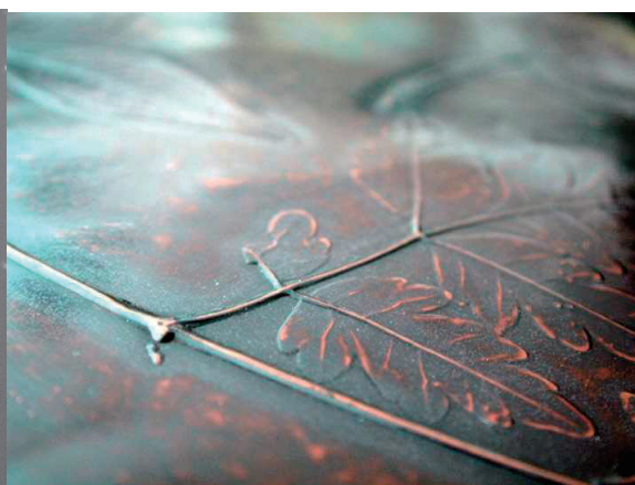
衝撃波成型による金属製植物標本
