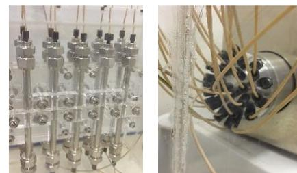
図2 擬似移動層型クロマト反応器の反応器管の配列(左)と特殊バルブ(右)
